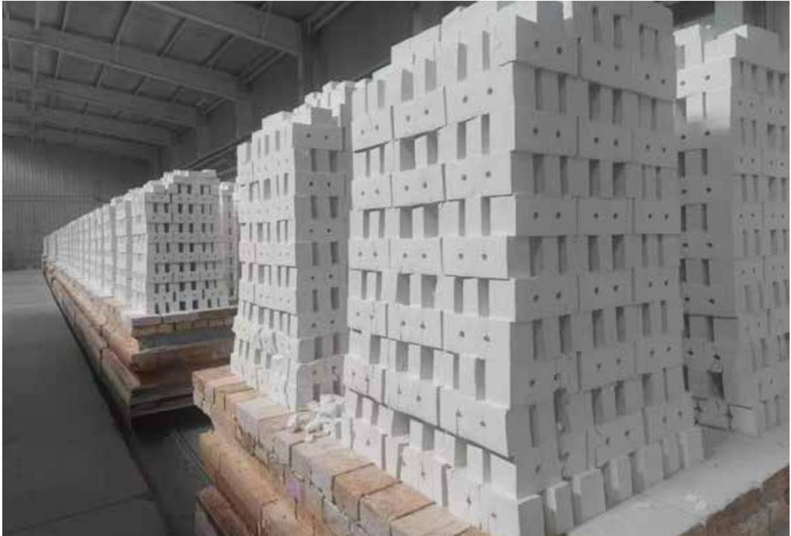
图 10 以炉渣、粉煤灰、煤矸石等工业固体废物研发制造莫来石
