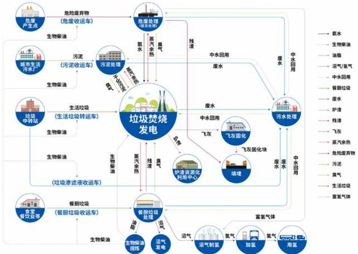
图 22 南海固体废物处理环保产业园多源固体废物协同处置模式
