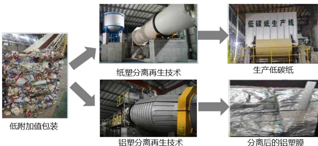
图 19 以低值废弃物纸塑分离、铝塑分离再生技术以及低值废弃物分拣再利用技术为核心的再生利用技术体系
