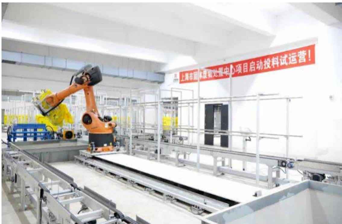
图1 上海市固体废物处置中心一期采用AGV自动投料装置的医废焚烧处置项目
